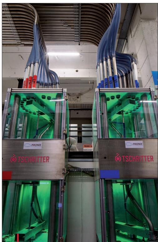
Des systèmes d'aiguillage robotisé garantissent une aspiration matière sans erreur.
