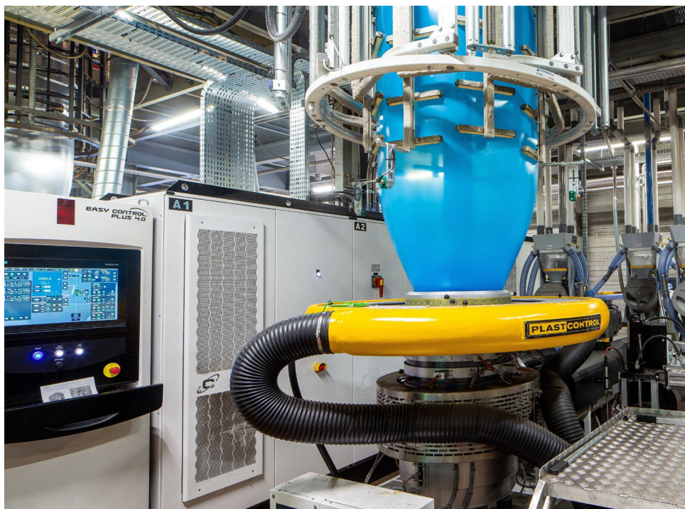
La co-extrudeuse la plus récente. Elle est destinée à la production du semi-fini pour l'impression, sa capacité de production est de 400 kg/h.
