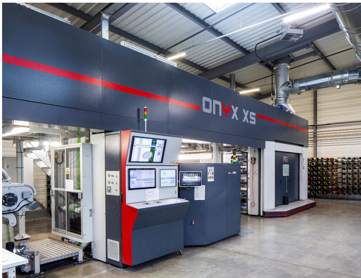
Imprimeuse flexo 8 couleurs Uteco Onyx pouvant imprimer jusqu'à 400m/min.
